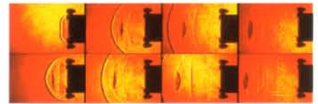
Bild 5: Schlieren-Folge des Heliumausstoßes einer Druckgaspistole (GASL, USA, aufgenommen mit einer Imacon, Belichtungszeit ca. 150 ns)
